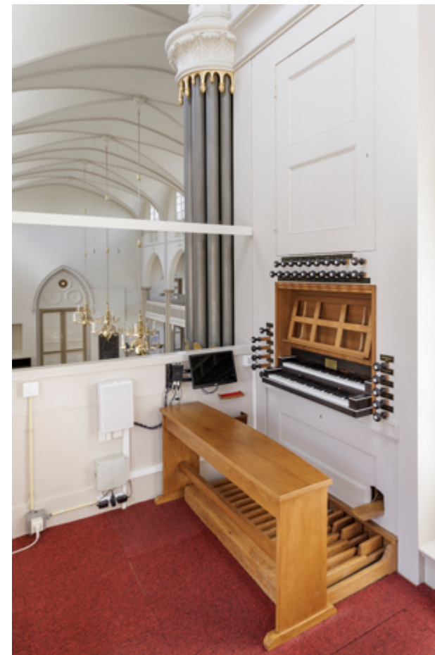
De speeltafel met klaviatuur opzij van het orgel maakt het mogelijk dat de organist in de kerk kan kijken.
