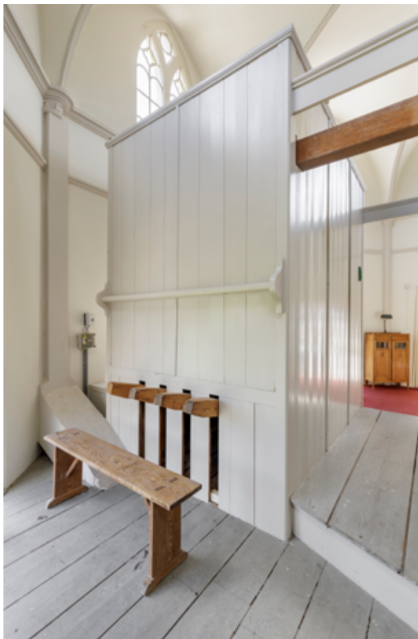
De balgenkast met windvoorziening opzij van het orgel. Via de pedalen moet de balgentrapper voor lucht in het instrument zorgen.
